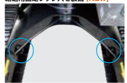
輸送時の機械固定用フック穴をトラックフレームの下フランジ部前後計4ヶ所に設けました。
