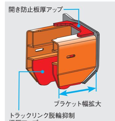
アイドラブルケット開き防止板厚およびトラックリンク脱輪抑制板厚を増加。外方向への開き防止と、トラックリンクおよびローラ類などの足回り部品の耐久性が向上しました。
