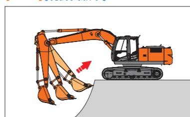
今まで、タンクに戻していたブーム戻りの圧油をアーム動作に再利用しました。この機構により、掘削時のアーム引き動作のスピードアップが大幅に図られました。
