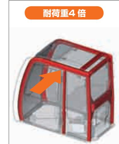
キャブの強度、剛性が大幅にアップした転倒時運転者保護構造を採用し、転倒に対する安全性を向上。この構造は、日本のJCMAが規定する安全基準(EOPS)に適合しています。例えば、キャブ上端部に横方向の荷重を加えた場合、従来機ZAXISに比べ4倍の荷重に耐えることができます。
