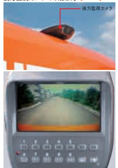
カウンタウエイト部に後方監視カメラを搭載。キャブ内のモニタで後方を確認でき、後進時の確認に役立ちます。
