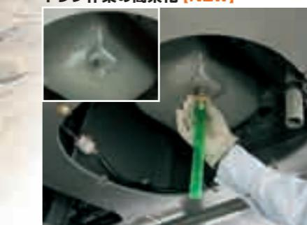
エンジンオイルパンにドレンカプラを装備。備え付けのノズルホースにより、容易にドレン作業が行えます。
