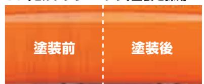
SC塗装は、親水性の塗料の自浄作用により、雨水と埃(ほこり)と一緒に流してしまいます。雨だれ跡がつきにくく、付いても落しやすい塗装です。
