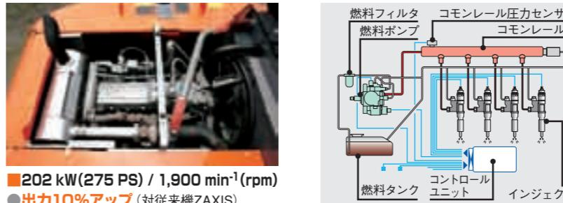
排出ガス3次規制に対応するため採用した新しいタイプの燃料噴射システムです。燃料ポンプを超高压で駆動し、気筒ごとのインジェクタに燃料を配分して噴射するシステムです。さらに、電子制御により1000分の1秒単位で燃料の噴射タイミング、噴射量をきめ細かに制御。この結果、燃料噴射量の最適化が図れ、高出力化ならびに不完全燃焼によるPM(黒煙などの粒子状物質)の低減や低燃費を実現します。
