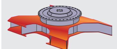
Xビーム構造のボックス寸法拡大や構造改良により、断面性能が最大で45%向上(対従来機ZAXIS)。さらに、上下板には1枚板の曲げ構造を採用しました。溶接部を減らすことで、Xビーム構造の強度および品質が向上しました。
