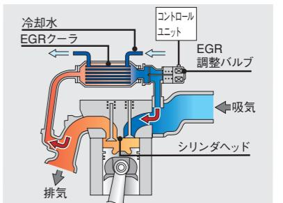
一度燃焼させた排出ガスの一部を吸入空気と混合し、再燃焼させる機構です。燃焼室内の酸素濃度を抑制することでEGRクーラーにより燃焼温度を下げることで、高出力を確保しつつ大気汚染物質であるNOx(窒素酸化物)の排出低減と低燃費を実現します。
