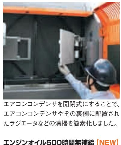
エアコンコンデンサを開閉式にすることで、エアコンコンデンサやその裏側に配置されたラジエータなどの清掃を簡素化しました。
