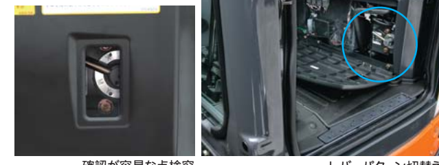
確認が容易な点検窓
