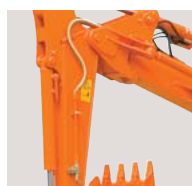
エキストラ配管
