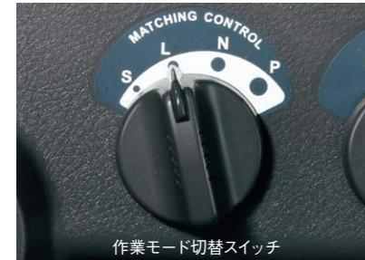
ZW150では、作業内容やオペレータの操作の好みに応じて選択できる4つの作業モードを用意しています。各モードは、独自に開発した業界初の電子制御式マッチングコントロールが作業機の油圧を検知し、走行用油圧モータのトルクを制御。4つの作業モードすべてで、けん引力と掘起力をベストマッチングさせます。これにより、オペレータの操作の好みにも柔軟に対応し、扱い物によりモード変更することで、燃費あたりの作業量の増大も可能となりました。
