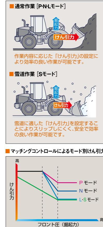
4つの作業モードごとにけん引力とフロント圧のバランスを電子制御によってコントロールします。よりけん引力が必要とする場合はPモードをセレクトします。
