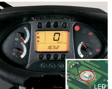
インジケータや警告表示、液晶モニタのバックライトなどに、LED（発光ダイオード）を採用。従来の電球や蛍光管と比べて長寿命で、球切れなどのトラブルが起こりにくいため、表示系の信頼性が大きく向上しています。
