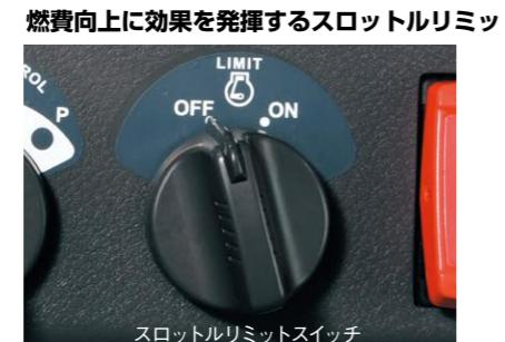
エンジンの最高回転数を10%抑えるスロットルリミットスイッチを搭載し燃費向上を図りました。HST車の場合、回転数を抑えて最大けん引力を発揮します。
