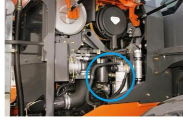
点検・交換しやすい位置に、燃料フィルタとエンジンオイルフィルタやウォーターセパレーターを配置しています。
