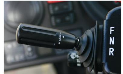
作業内容によって最高速を4段階に選択できるフルオートマチック型HSTを採用しました。変速時のショックが少なくスムーズな動きを実現します。
