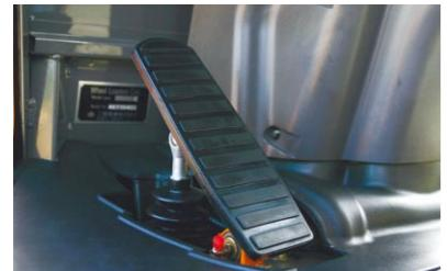
ブレーキ/インチングペダルはアクセル操作とは無関係に車速に相当する走行用油圧ポンプの吐出量を調整します。この結果、ブレーキ/インチングペダルだけで車速の調整が可能です。積込みの際の位置合わせを容易に行えます。
