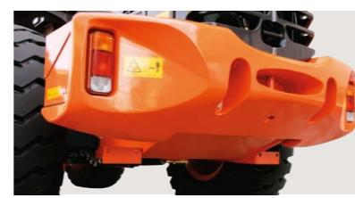
車体後部、後側部を接触・追突からまもる、大型カウンタウエイトを装備しています。
