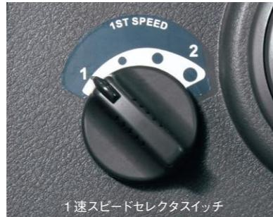
1速の最高速度を選択可能。積込み作業などで現場の広さに応じた車速を選択することにより、微妙なアクセルやブレーキ操作を軽減できます。
