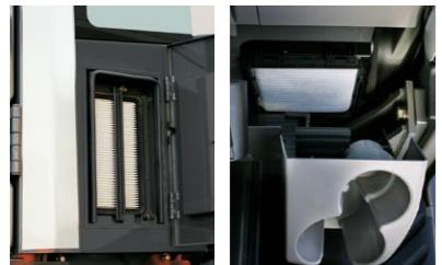
外気フィルタは、キャブ外側から簡単に交換できます。また、内気フィルタもキャブ内のドリンクホルダ部を外すだけで簡単に交換できます。
