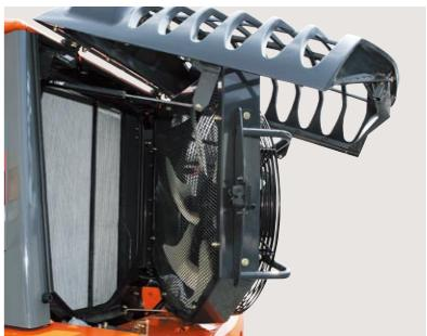
温度感知型油圧駆動の冷却ファンは、清掃時などに逆回転させることが可能。これにより、手軽な操作でラジエータに詰まつたごみなどを取り除くことが可能です。また、油圧駆動ファン自体も、ヒンジによって開閉が可能ですので、エアブローによる清掃作業も行えます。
