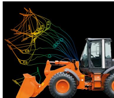
新パラレルタンデム回路の導入により、従来機ではできなかったリフトアームとバケットを同時に動かす複合動作が可能になりました。掘削や積込みといったフロント作業を効率良く、スムーズに行えます。
