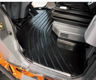
キャブドア周辺のデザインを変更し、段差のないフラットなフロアを実現。ほうきで掃くだけの手軽な作業で、キャブ内の掃除ができます。
