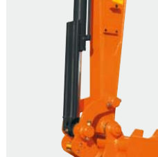
強化型山形バケットシリンダガード
