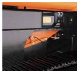
3 クラッシャ下部左右側方の開口部 (撮影のためカバーを取り外しています)
