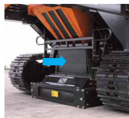
2 コンベヤテール部
