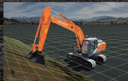
位置情報により掘削面を認識
