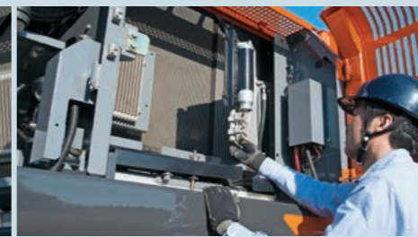
開閉式のエアコンコンデンサ
