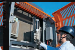
開閉式のエアコンコンデンサ
