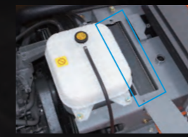
ワンタッチ開閉式のラジエータ清掃窓
