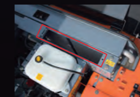
ワンタッチ開閉式のラジエータ清掃窓
