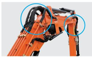
ブーム・アーム間の基本配管ホース、アームシリンダホースにホー スプロテクタを追加し油飛散を防ぎます。
