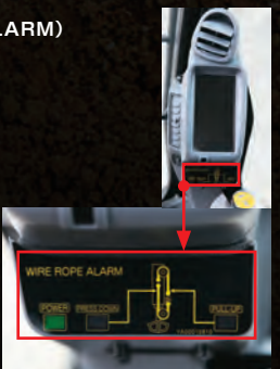
ロープ異常警報装置
