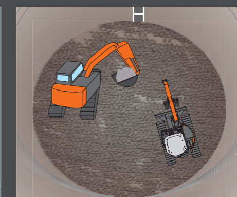
● 深礎工事 (大口径深礎)
