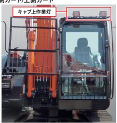
オペレータ保護のためキャブ前面上・下ガードを装備。 上側ガードは、開閉できるので窓の清掃が容易。 暗所での作業も容易に対応できる、キャブ上作業灯を標準装備。
