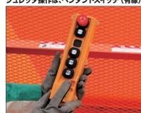
投入ホッパでの破砕状況を見ながら操作が できるので、シュレッダへの過大な負荷を掛 けずに済み、生産性を維持します。
