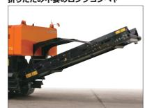
輸送時の全長が、9,510 mm (輸送時全高 3,170 mm) とコンパクト。現場での準備、段 取り作業が不要です。排出高さは、2,550 mm を確保、4 tトラックへ直接排出が可能です。
