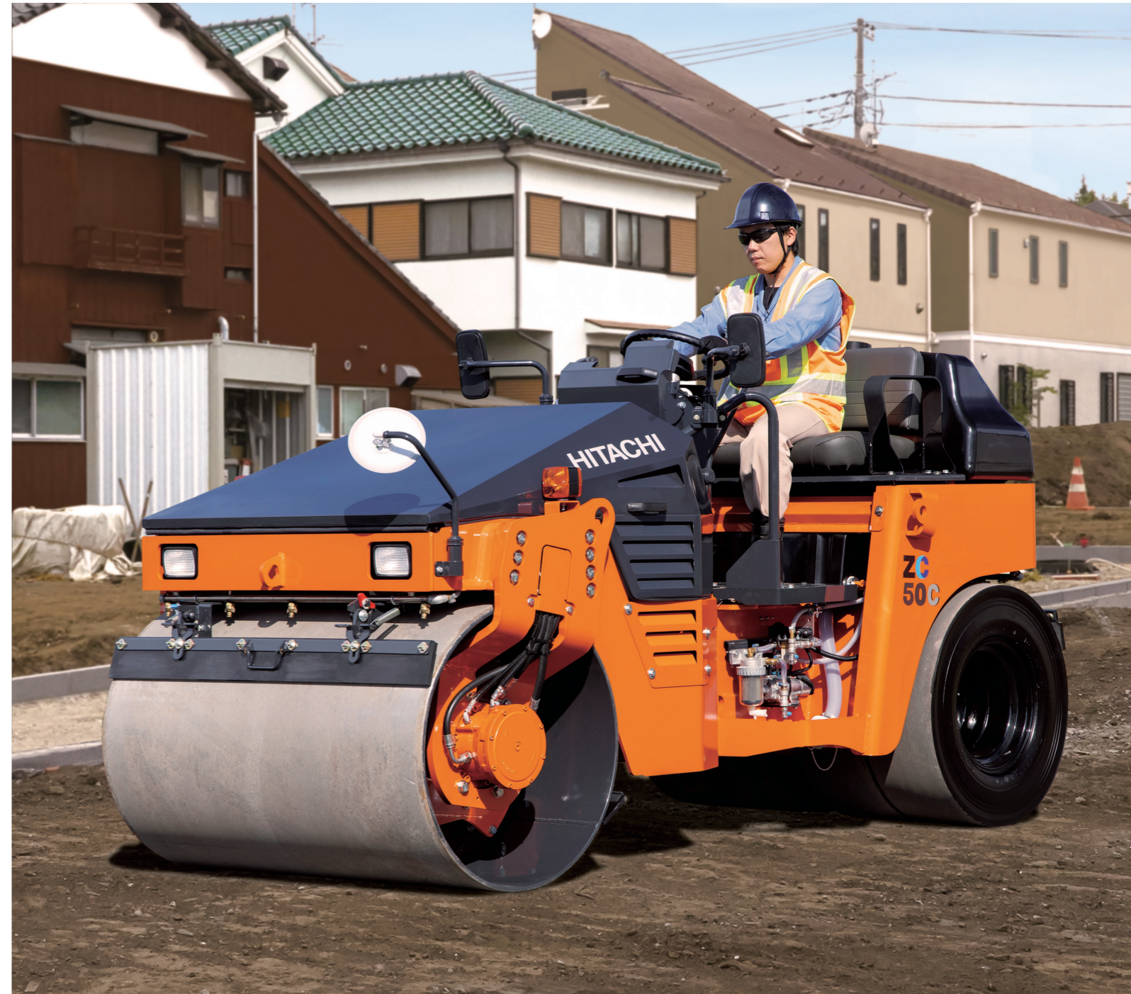
※写真はオプションのドラム下側スクレーパーを装着しています。
