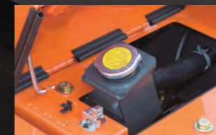
エキスパンションタンク
