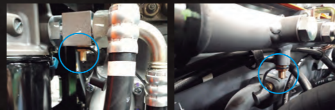
エンジンオイルサンプリングポート 作動油サンプリングポート
