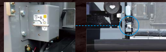
バッテリーディスコネクトスイッチ (車体左側)
