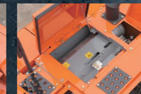
清掃性が向上したマフラフィルタ周り
