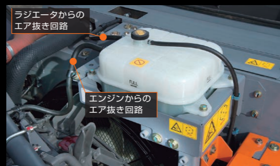
エキスパンションタンク
