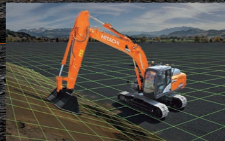
位置情報により掘削面を認識
