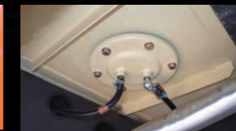
内部を清掃しやすくなった燃料タンク
