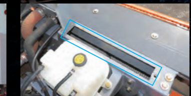
ワンタッチ開閉式のラジエータ清掃窓
