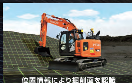
位置情報により掘削面を認識
