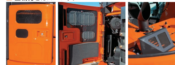
車体開口部に金網を装備することにより、車体内部へ粉塵が侵入するのを抑制します。
