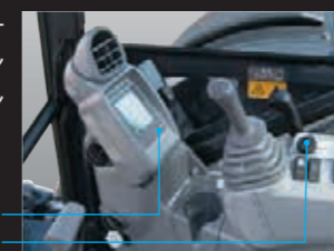
ECO/PWRモード切替えスイッチ エンジンコントロールダイヤル
