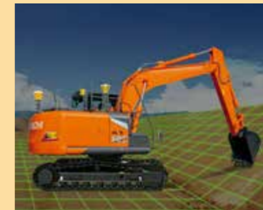
位置情報により掘削面を認識。
