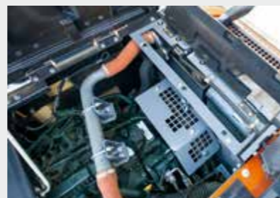
ラジエータ清掃窓
