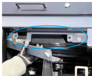
ラジエータ清掃窓
