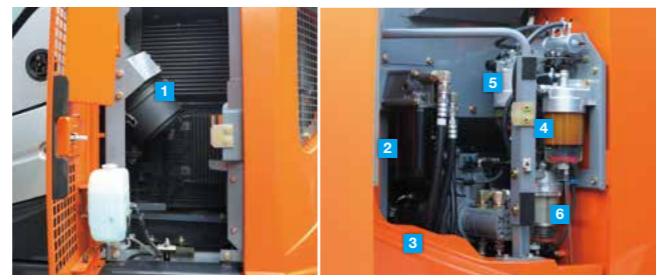
1 エアクリーナ 2 エンジンオイルフィルタ 3 パイロットフィルタ 4 燃料プレフィルタ 5 燃料メインフィルタ 6 ウォータセパレータ (オプション)
