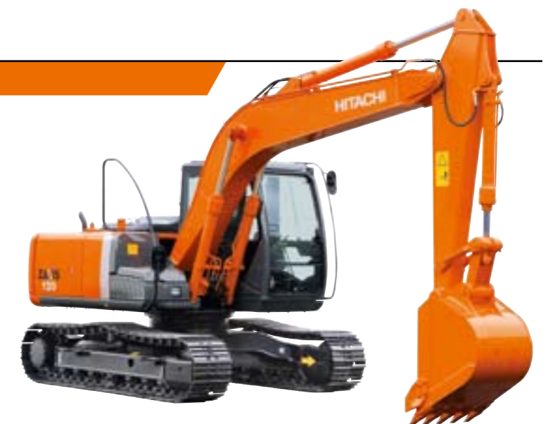
※写真は、オプションの2.10 m ショートアームとトラックガードを装着しています。
