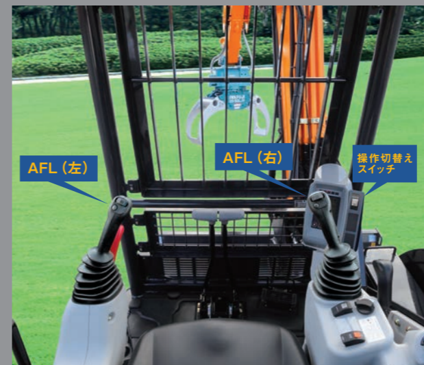
※電磁弁不付きグラップルとウインチを取り付けた場合の操作方式。
