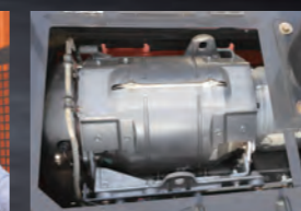
清掃性が向上したマフラフィルタ周り
