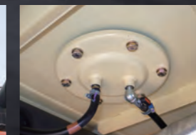
内部を清掃しやすくなった燃料タンク
