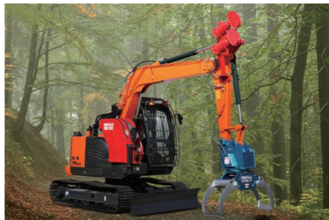
写真は、イワフジ工業製グラップルGS-65LJV、およびウインチSW-202を装着しています。
