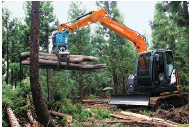
ZX75US-5B グラップルパッケージ機 写真にはパッケージに含まれないアタッチメント(グラップル)、 キャブガードが装着されています。
