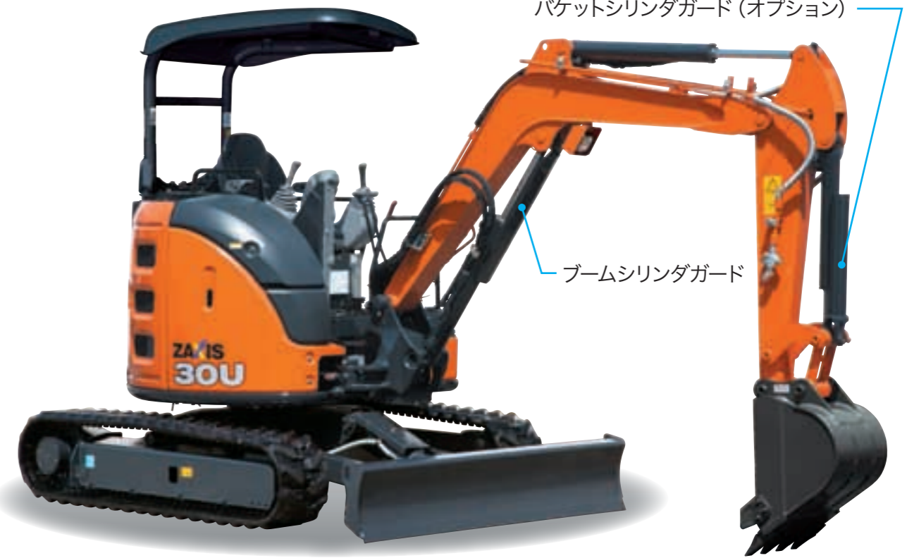
ZAXIS 30U (2柱キャノピ、アタッチメント配管仕様) ※オプションの4面補強アームおよび鉄クローラ、バケットシリンダガード、ホースプロテクタ、アームレスト付き
