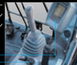
ECO/PWRモード切替えスイッチ エンジンコントロールダイヤル
