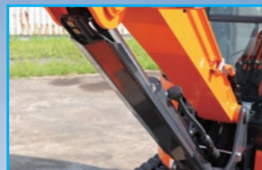
ブームシリンダカバー 山形保護プレートにより、ブームシリンダロッドを保護します。
