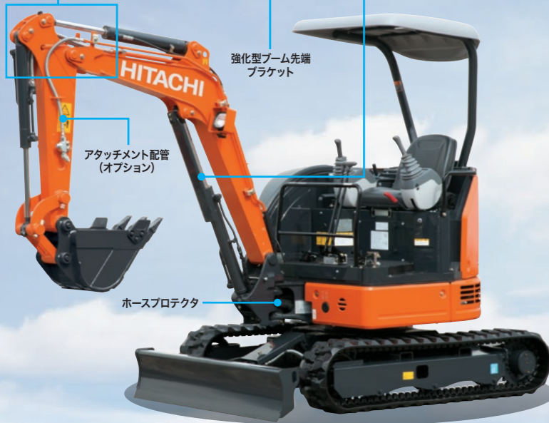
油圧ホースガード バケットホースをアームの内側に配置し、ホースを保護します。
