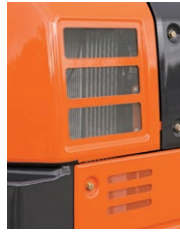
防塵ネット 吸気側開口部に防塵 ネットを追加しました。
