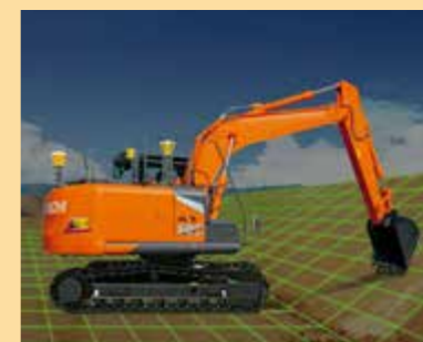
位置情報により掘削面を認識。
