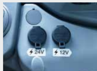
24V電源と 12V電源 NEW
