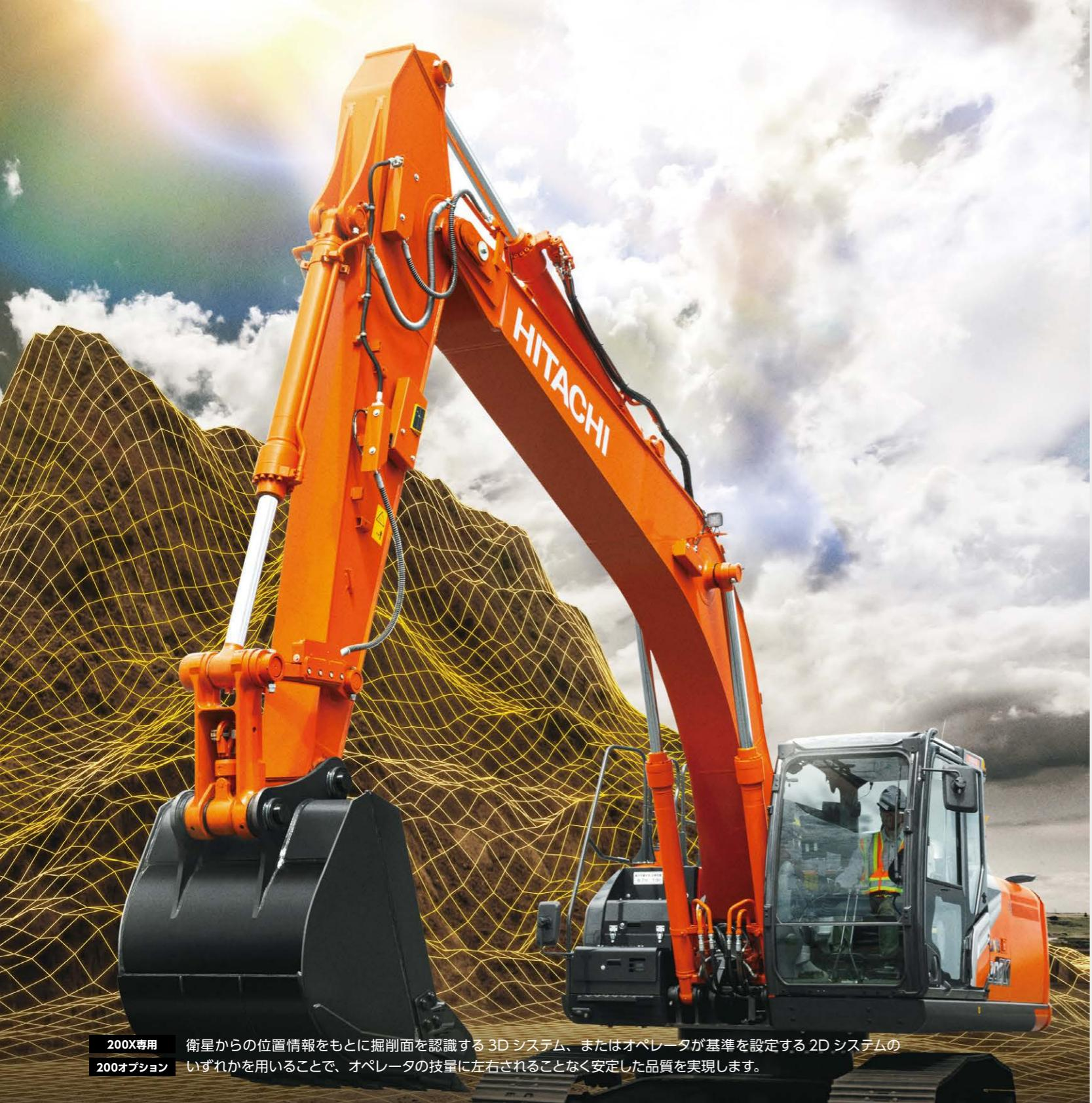
**200X専用** 衛星からの位置情報をもとに掘削面を認識する3Dシステム、またはオペレータが基準を設定する2Dシステムの
