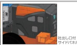
ラジエータに入り込む大きなゴミを事前にキャッチするラジエータダストスクリーンを装備。清掃の手間を省き、オーバーヒートのリスクを低減します。また、清掃しやすい車体後方側でゴミをキャッチするため、サクシジョン (吸い込み) ファン、吐出し口付サイドパネルとセットです。
