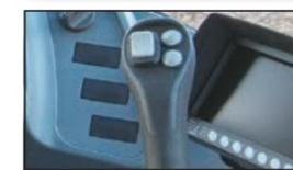
前後進切替とホーン、クイックシフト (QSS) の操作を1つのレバーに集約。作業状況に応じたスムーズな連動操作を実現します。
