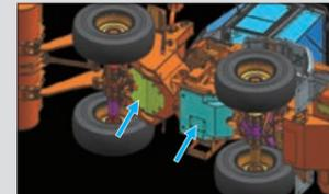
作業中、ガラや鉄筋など、車体下部からの突き上げからトランスミッションなど車体を保護します。
