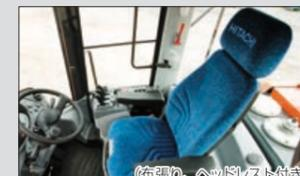
車体の振動をオペレータに伝えにくいエアサスペンションシート。快適な運転姿勢で長時間運転の疲労を低減します。(布張り、ヘッドレスト付き)
