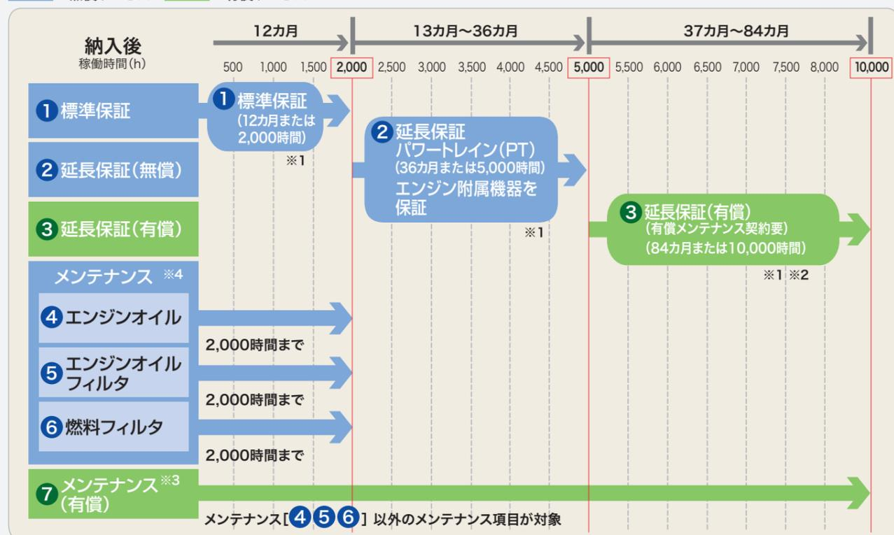
※1 日立建機純正部品を使用した適切なメンテナンスを実施することで各保証が付帯されます。
