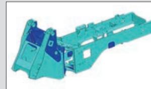
ハードな作業環境でも安心してご使用頂ける産廃専用フレームを装備。単純な追加補強のみならず、各部の板厚から見直した専用フレームです。
