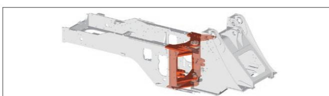
応力が集中するセンターヒンジ付近にボックス断面構造体を導入。3D応力解析から得られた最適な板厚によるメインフレーム構造、結合部に効果的な補強を加えるなど、車両の高剛性化を実現しました。
