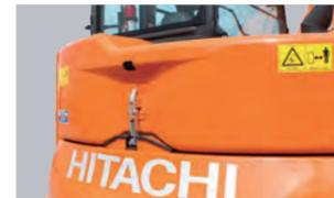
後方監視カメラの設置場所をエンジンカバー上部から内蔵型に変更し、接触による破損を低減。さらに、カウンタウイト直近の視界性も向上しました。
