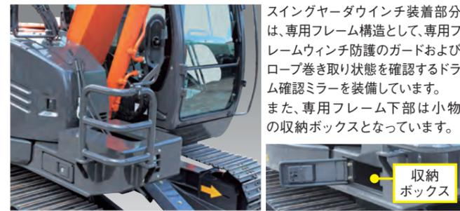
スイングヤーダ用装備品は、専用フレーム構造として、専用フレームウィンチ防護のガードおよびロープ巻き取り状態を確認するドラム確認ミラーを装備しています。また、専用フレーム下部は小物の収納ボックスとなっています。
