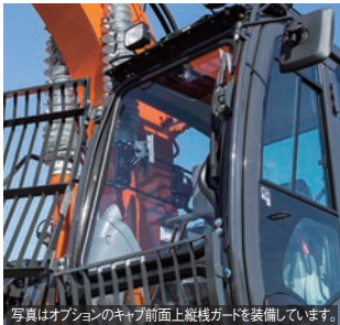
写真はオプションのキャブ前面上縦横ガードを装備しています。
