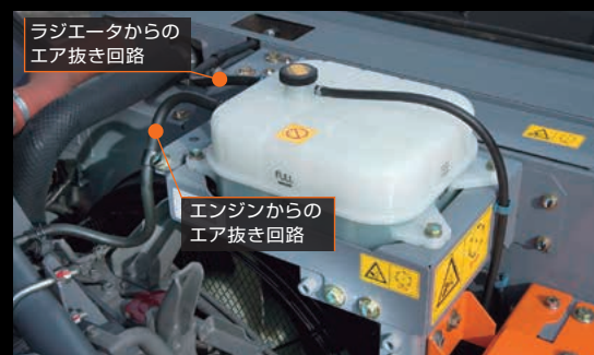
エキスパンションタンク
