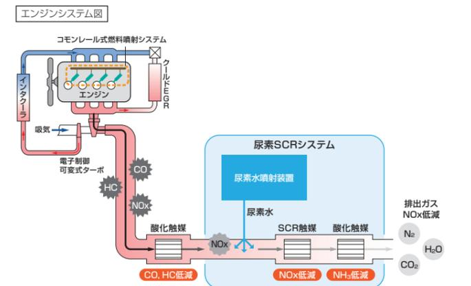
**尿素 SCR システム**: 「尿素 SCR システム」は NOx を浄化する後処理技術です。エンジンの排出ガスは、連結パイプ内で噴射された尿素水 (アンモニア) と混合し、SCR 触媒および DOC (ディーゼル酸化触媒) によって無害な水と窒素に分解。排出ガスのクリーン化に貢献します。
