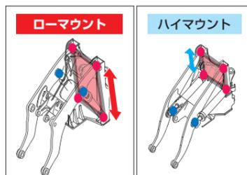
ピン間距離を十分に確保し、掘削時のリフトアームねじれを効率的に受けるローマウントリフトアームシリンダ方式を採用。さらにフロントアクスルの上に堆積した土砂や石によるリフトアームシリンダの破損を未然に防止します。
