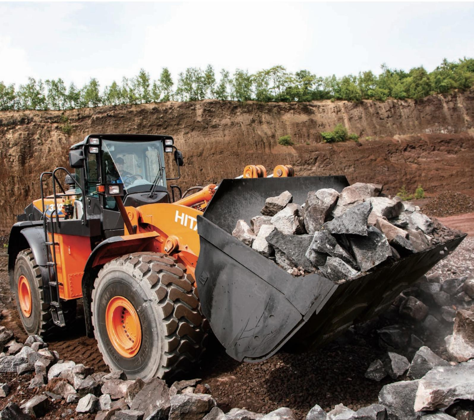
写真はオプションのラジアルタイヤ、フルフェンダ（マッドフラップ付き）、追加前方作業灯（キャブ用、2灯）、自動給脂装置（欧州専用）を装備しています。
