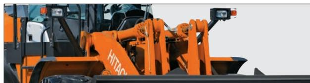
原石積込みにおける偏荷重に対し、十分な耐久性を有するダブルZバーリンクージを採用しました。掘削・積込み時の荷重を効率的に分散させ、各ピンの耐久性が向上、ねじれに対する剛性を高めました。
