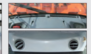
エアコン吹き出し口&デフロスタ
