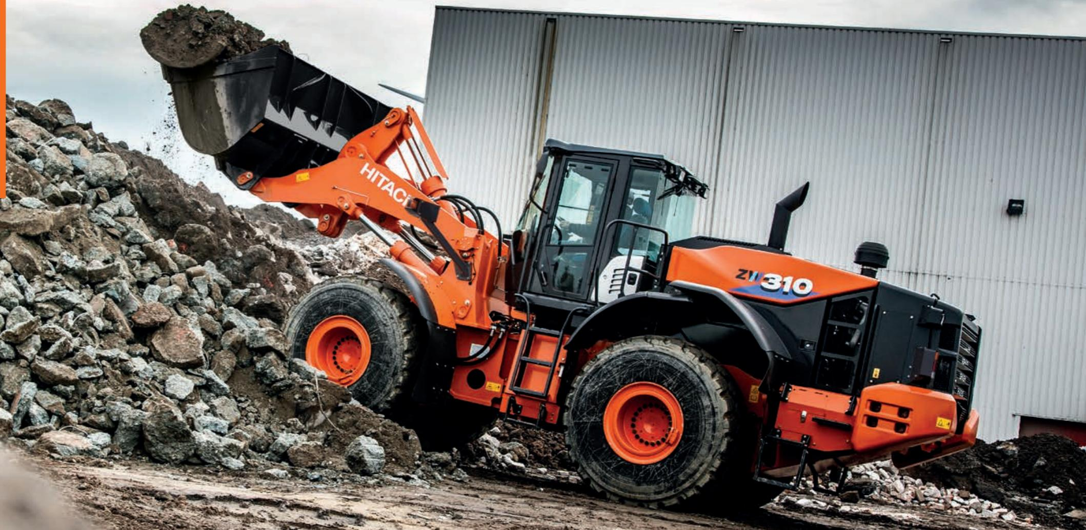
写真はオプションのラジアルタイヤ、フルフェンダ（マッドフラップ付き）、プレクリーナ（サイクロン式）、後方作業灯、バケットシリングダロードガードを装備しています。
