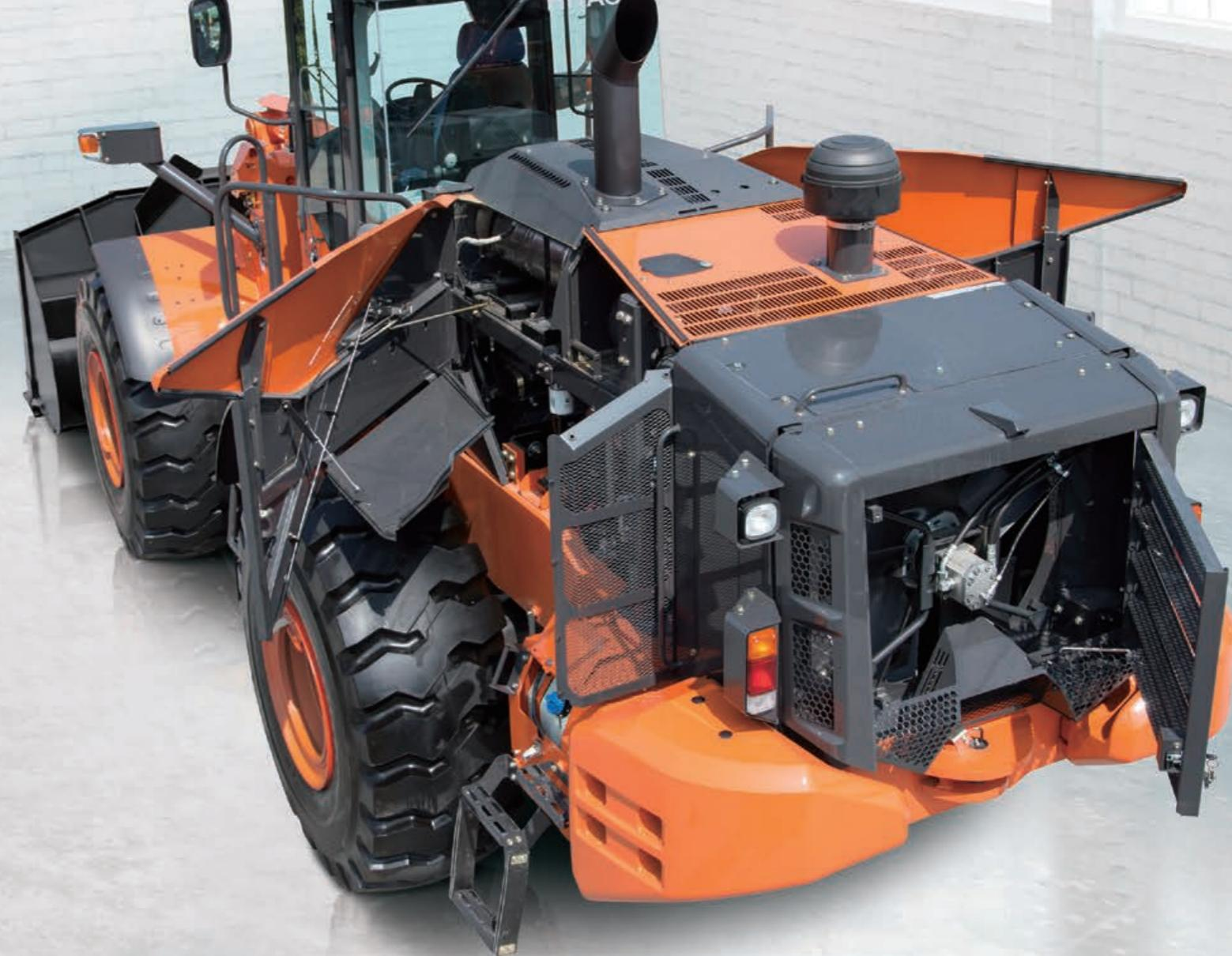
写真はオプションの1960 kg カウンタウエイト、プレクリーナ（サイクロン式）、バケットシリングラードガードを装備しています。
