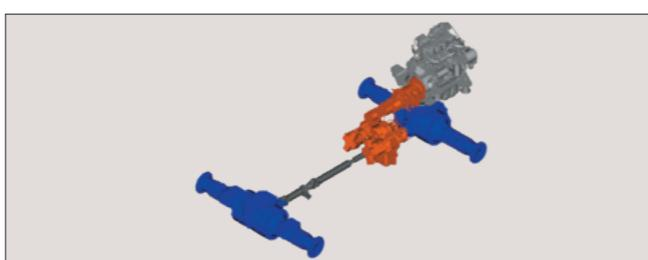
積荷走行が多い欧州の現場で実証された、信頼性・耐久性が高いトランスミッションを採用しました。アクスルは、ハウジング形状の最適化や最適部材などで過酷な路面環境に耐えられる信頼性を実現しています。
