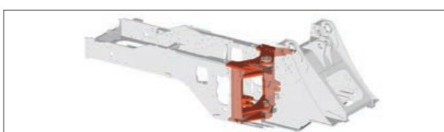
応力が集中するセンタヒンジ付近にボックス断面構造体を導入。3D応力解析から得られた最適な板厚によるメインフレーム構造、結合部に効果的な補強を加えるなど、車両の高剛性化を実現しました。
