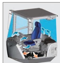
温度設定によって、風量や吹き出し口、温度を自動的にコントロール。さらに、足元を暖かく、顔部分を冷やすといったように、場所によって温度を変えることができるバイレベル機能を搭載。また、キャブ内の気圧を外部よりわずかに高めた加圧キャブは碎石現場などで発生する非常に細かい粉じんの侵入を防ぎ、キャブ内を清潔に保ちます。また、ほこりの多い現場向けに、エアコン外気ダブルフィルタをオプションで用意しています。
