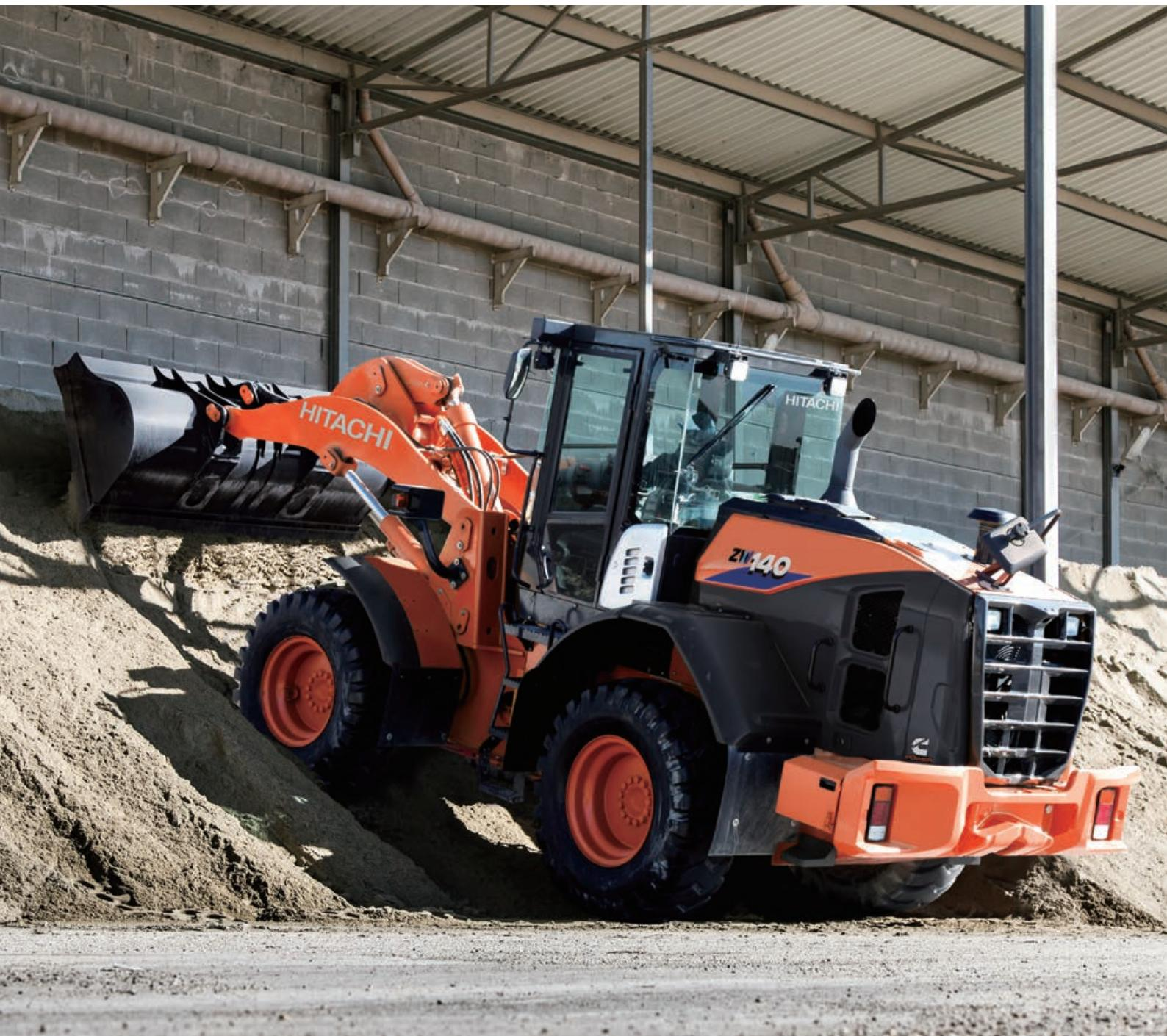
写真はオプションの追加前方作業灯(キャブ用、2灯)、後方作業灯(キャブ用、2灯)、フルフェンダ(マッドフラップ付き)、リアコンビネーションランプ(LED)を装備しています。
