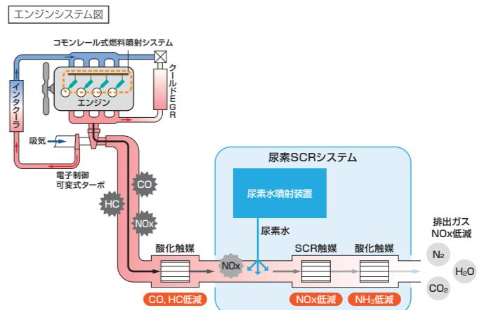
**尿素SCRシステム:**「尿素SCRシステム」はNOxを浄化する後処理技術です。エンジンの排出ガスは、連続パイプ内で噴射された尿素水(アンモニア)と混合し、SCR触媒およびDOC(ディーゼル酸化触媒)によって無害な水と窒素に分解。排出ガスのクリーン化に貢献します。
