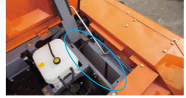
ワンタッチ開閉の窓からラジエータ裏側の清掃も可能
