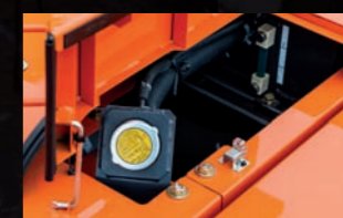
エキスパンションタンク
