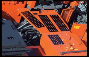
滑り止めプレート
