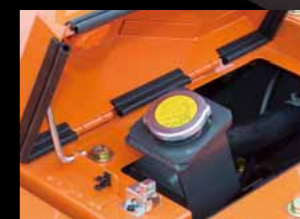
エキスパンションタンク
