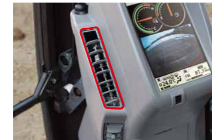
エアコン吹き出し口
