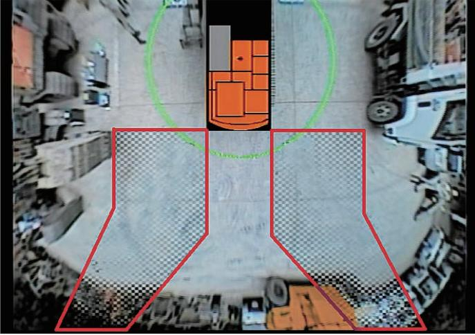
3台のカメラ映像を日立独自の画像技術で処理。映像ラップ部分を合成加工し、死角を低減しています。(赤枠内メッシュ部分が合成加工部分)
