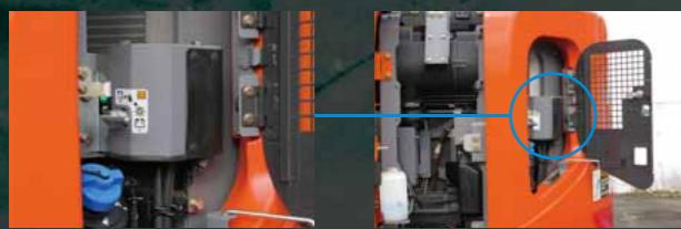
レバーを動かすだけで、簡単にバッテリを遮断できます。メンテナンス中の感電事故を防ぎます。
