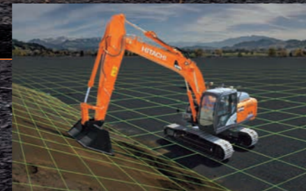
位置情報により掘削面を認識
